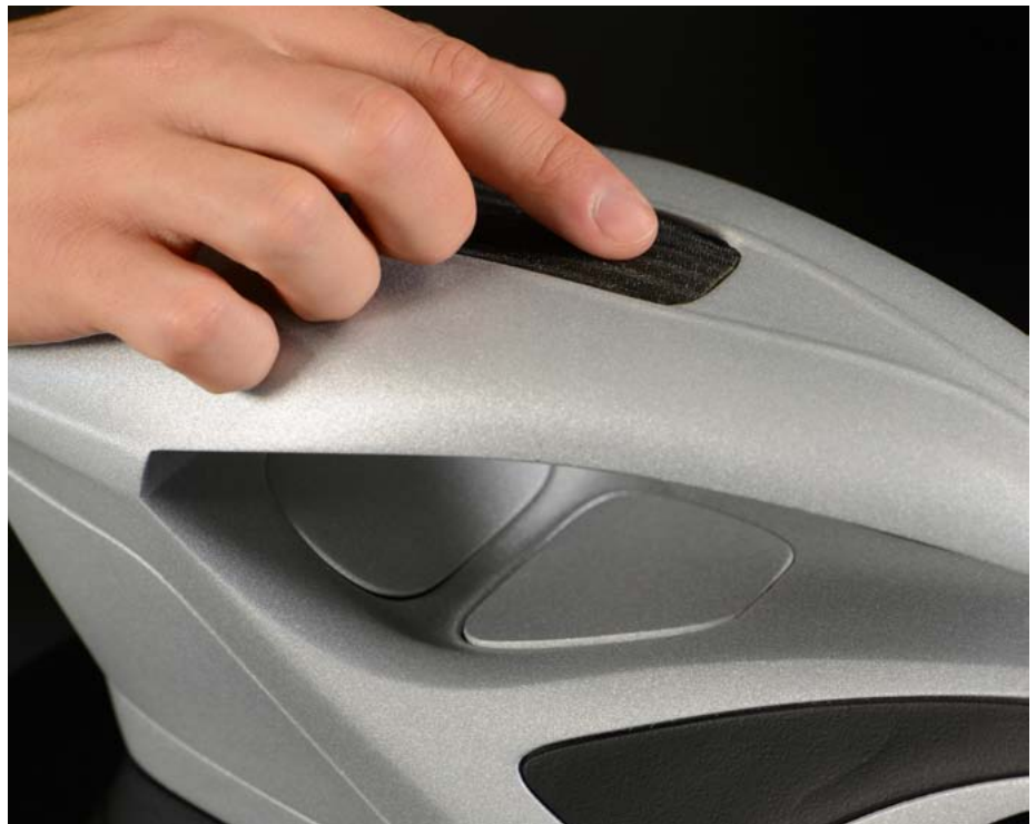
Designstudie für neue haptische Bedienelemente auf der Basis von DES und Piezosensoren (© K. Dobberke für Fraunhofer ISC)
