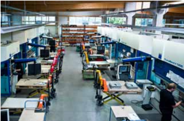
Bild 1: Blick in eine Fertigungshalle mit nicht verketteten Maschinen
