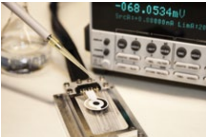
Siebgedruckter Elektrolytsensor für die Überwachung flüssiger Betriebsmittel.
