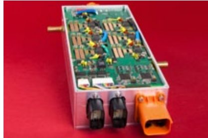
Hocheffizientes isolierendes bidirektionales On-board-Ladegerät mit selbstsperrenden Galliumnitrid-Transistoren, hoher Leistungsdichte und hohem Wirkungsgrad für Elektrofahrzeuge.
