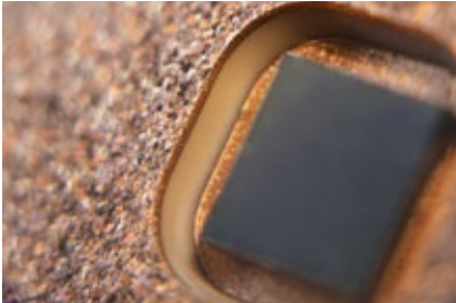
Keramischer Schaltungsträger mit eingebetteten Wide-Bandgap-Leistungsbauerelementen für hohe Ströme, hohe Spannungen und hohe Temperaturen.
