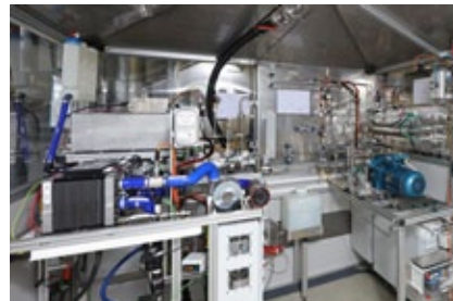
Wasserstoffprüfstand mit brennstoffzellenbasiertem Verstromungssystem für wasserstoffreiche Prozessabgase aus Halbleiterfertigungsanlagen.
