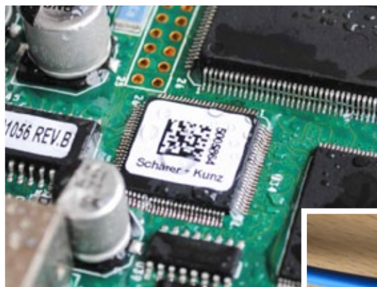
Leiterplattenkennzeichnung für lückenlose Nachverfolgbarkeit (Traceability)
