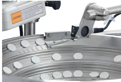
Zuführsystem für Silikonscheiben im Edelstahl Fördertopf
