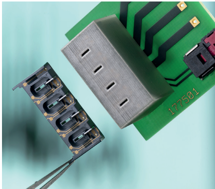
Drahtloser intelligenter Leiterplatten Steckverbinder zur kontinuierlichen Messung von Kontakttemperatur und Strombelastung des einzelnen Kontaktes als Basisdaten für vorbeugende Wartung.
