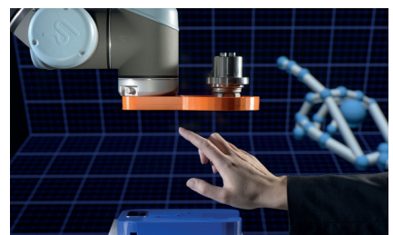
Mensch-Roboter-Kooperation: Gestensteuerung. ©Fraunhofer IGCV/Bernd Müller
