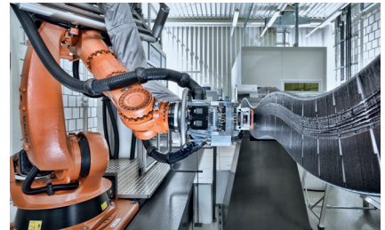
Leichtbau: CFK-Fertigungsprozess Automated Fiber Placement. ©Fraunhofer IGCV/Thomas L. Fischer
