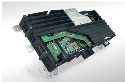
Intelligente Energieweiche für ausfallsichere Stromversorgungen speziell in autonomen Fahrzeugen.
