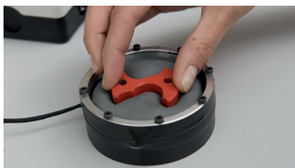
Magnetorheologische Fixierung – Anpassung an beliebig geformte Werkstücke möglich. K. Dobberke für Fraunhofer ISC
