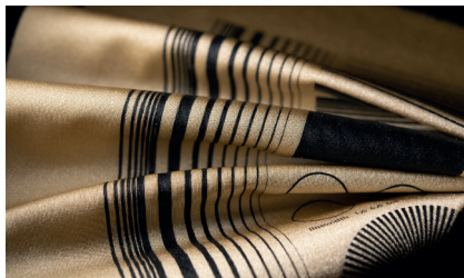
Gedruckte elastische Sensorik auf Textil. K. Selsam, Fraunhofer ISC
