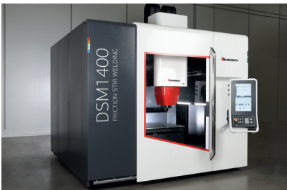
Mit der Rührreißschweiß-Technologie von Grenzebach lassen sich Schweißnähte mit ausgezeichneten äußeren und inneren Eigenschaften erzeugen.
