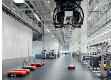
Fahrerlose Transportfahrzeuge von Grenzebach ermöglichen die Automatisierung von Transportaufgaben im Lager und in der Produktion. Die Koordination übernimmt der Flottenmanager.
