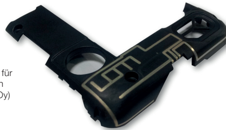
Großflächige 3D Heizmuster – Automotive Demonstrator
