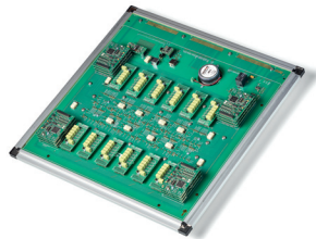
TEST-OK - Modulprinzip, Untersicht mit produktspezifischer Hardware
