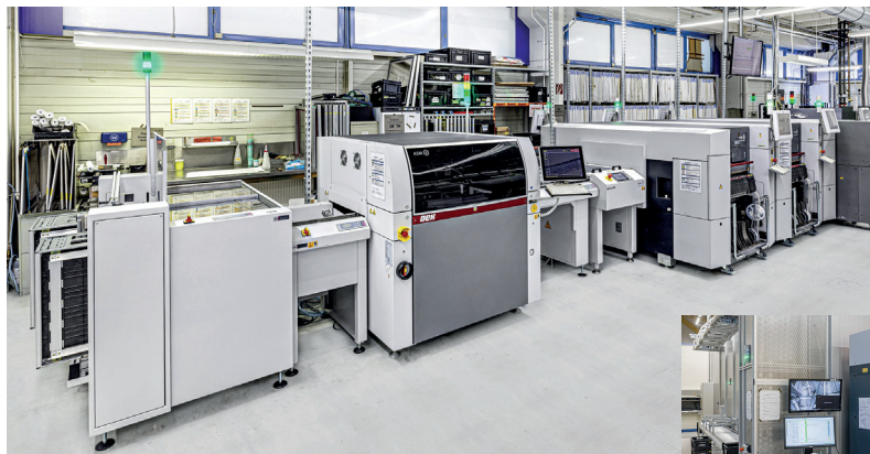
SMT-Fertigungslinie bei elektron systeme
