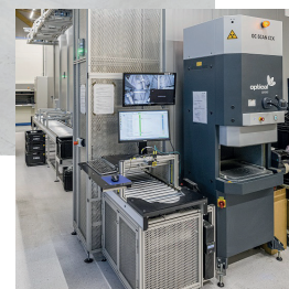
vollautomatisiertes Lagersystem für ca. 90 Mio. Bauteile
