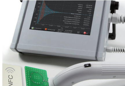
FPGA-basiertes Messgerät zur Charakterisierung von RFIDs
