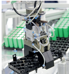
Kombinierter Backensauggreifer zur Handhabung von Zellhalterungen
