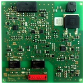
Die im Projekt AmWind entwickelte Platine ermöglicht Zustandsüberwachung der Leistungselektronik in Offshore-Anlagen über große Entfernungen. © Fraunhofer IZM
