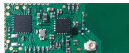
Abb. 2: XoverIoT Modul mit U-FL Buchse für externe Antenne
