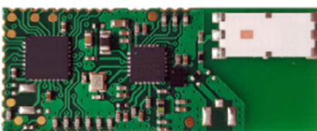
Abb. 1 XoverIoT Modul mit Chip-Antenne
