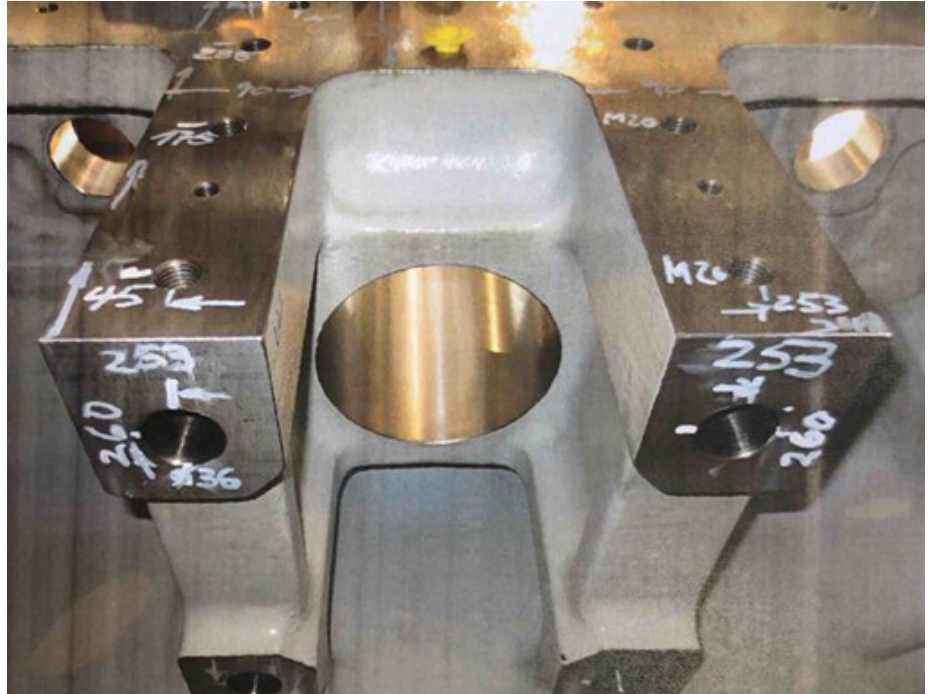
Abb. 2: Bohrung im Zylinderkurbelgehäuse
