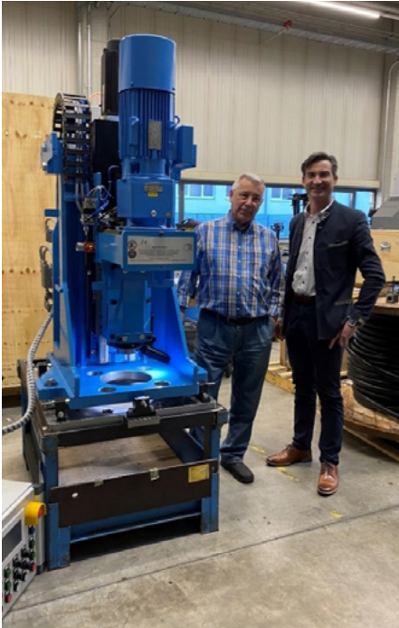
Abb. 1: Für die Umrüstung von Schiffsmotoren braucht es ein Sonderwerkzeug, genauer gesagt eine transportable Spindelmaschine.
