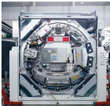
Mechatronische Integration am Beispiel eines Computertomographen
